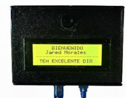
Figura 3. Función de mensaje en la pantalla LCD al reconocer a una persona registrada.
