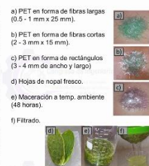
Figura 1. Extracción del inhibidor y geometría del PET.
